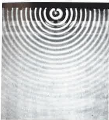
Fig. 39. Ringformede periodiske bølger i et bølgekar. De lyse ringe er bølgetoppe. Bølgerne kaldes periodiske, fordi afstandene mellem bølgetoppene overalt er den samme.
