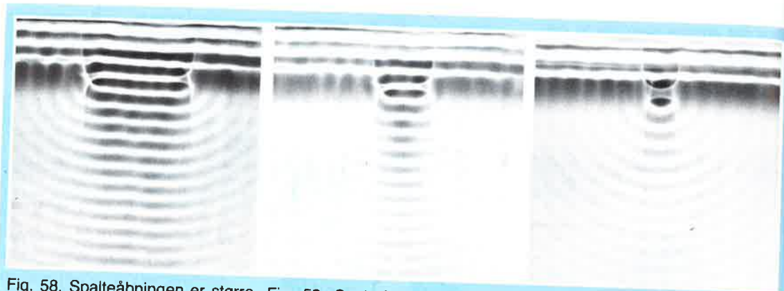
Fig. 60. Spalteåbningen er lig med bølgelængden.
