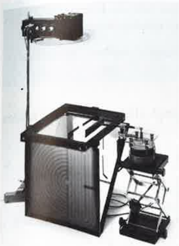
Fig. 38. Bølgekar til forsøg med vandbølger.
